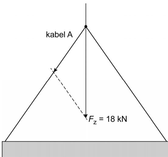
( $F_A =$ ) 11 (kN) ( $10,3$  (kN)  $\leq F_A \leq 11,7$  (kN) goed rekenen)
