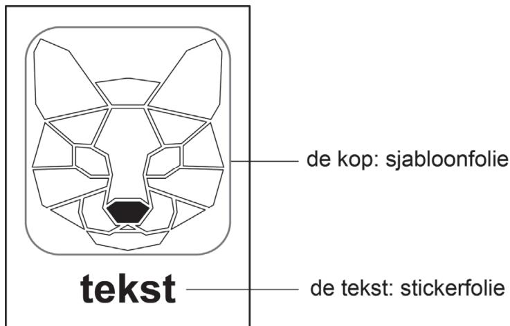
Laat de examinator voor beide soorten folie de plotter positioneren en de instellingen in het programma controleren.
