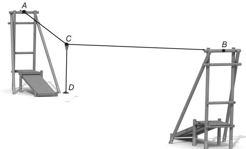
De kabel is op een hoogte van 3,75 m vastgemaakt bij de punten  $A$  en  $B$ . Over de kabel beweegt katrol  $C$ , waaraan het stoeltje  $D$  is vastgemaakt met een kabel van 1,65 m. In het assenstelsel zie je een schematisch zijaanzicht van de kabelbaan, waarbij katrol  $C$  in het midden hangt.
