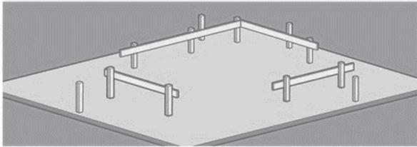
In de volgende opdracht ga je een bouwraam controleren en de maten van de fundering en de spouwmuur erop aftekenen.
