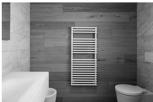
De inhoud van de badkamer is 32 m<sup>3</sup> en de designradiator levert 2988 watt aan warmtecapaciteit.
