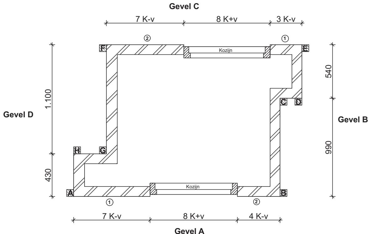
In het lokaal zijn lijnen aangegeven die de **binnenkant** van deze gevels voorstellen. Ook zijn de profielen en kozijnen opgesteld.
