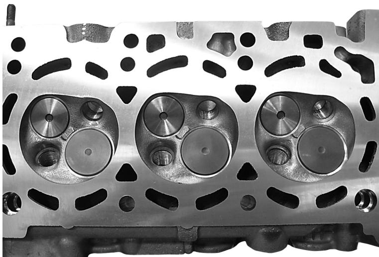
→ Waarom is er een verschil in diameter tussen de kleppen?
