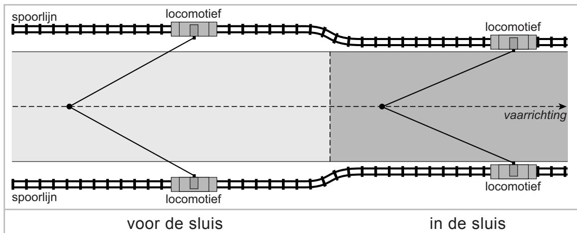
De locomotieven leveren tijdens het slepen steeds een even grote kracht. Wat is juist over de resulterende kracht die de locomotieven leveren op het schip?
