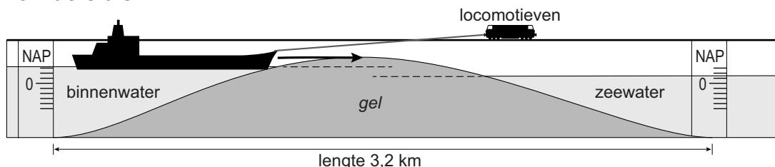
Twee locomotieven slepen een schip door de gel. Hiermee kan de wachttijd voor schepen flink korter worden. De weggeduwde gel wordt in het midden van de sluis weer teruggepompt.
