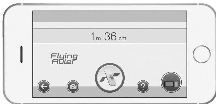
De smartphone zendt geluid uit. Even later ontvangt de smartphone het weerkaatste geluid. Met het tijdsverschil tussen zenden en ontvangen berekent de smartphone de afstand tot een voorwerp.
