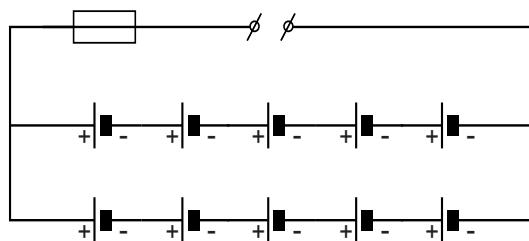
De accu's in het accupakket leveren samen een spanning van 320 V aan de elektromotor.
